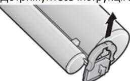
1. Щоб відкрити картридж, перемістіть фіксатор угору. Не змінайте фіксатор із картриджа.
